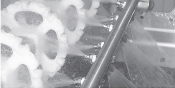
Figure 120: Profil de vaporisation conçu pour le nettoyage des surfaces inférieures du tapis, des pignons et de l'arbre
