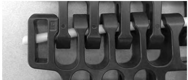
**Figura 319:** Empurre a vareta, passando pela peça de retenção
