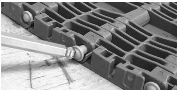
**Figura 272:** Empurre a mini-vareta através da peça de retenção
