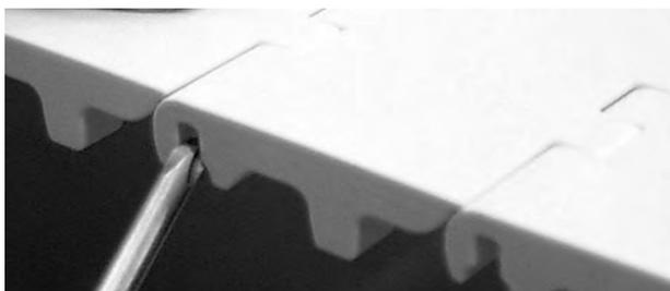
**Figura 205:** Empurre a vareta através da peça de retenção
