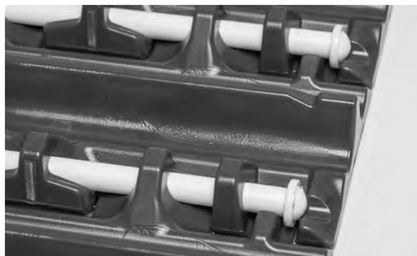
**Figura 95:** Confirme que a vareta passe pela peça de retenção
