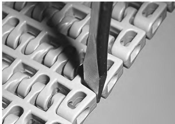
**Figura 139:** Empurre a vareta, passando pela peça de retenção
