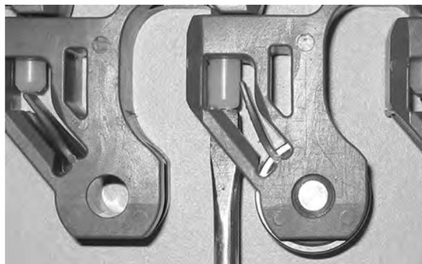
Figura 305: Empurre a vareta, passando pela peça de retenção
