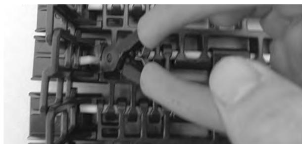
**Figura 372:** Empurre a vareta, passando pela peça de retenção
