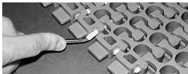
Figura 276: Confirme que a vareta passe pela peça de retenção
