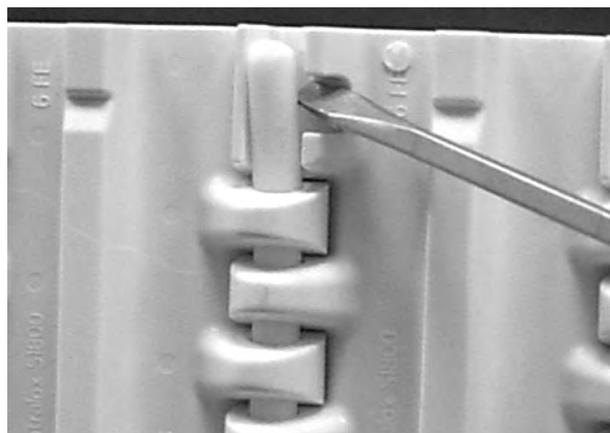
**Figura 207:** Levante a vareta sobre a peça de retenção
