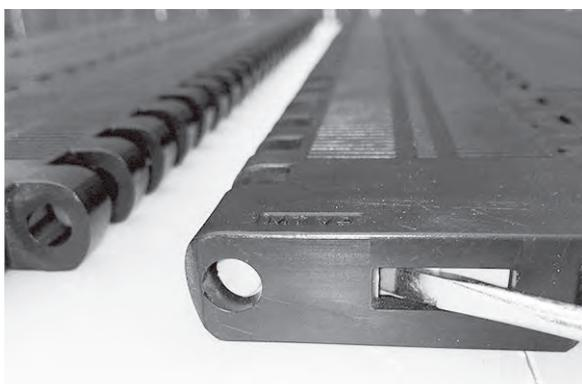
**Figura 210:** Use uma chave de fenda para fechar o Slidelox
