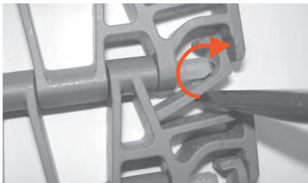
**Figura 254:** Gire a chave de fenda para manter a peça de retenção aberta
