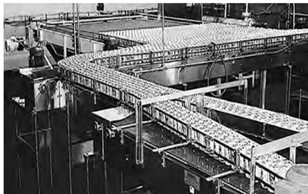
**Figura 23:** Coloque os suportes ao longo da largura da esteira
