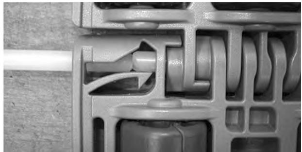
Figura 223: Empurre a vareta, passando pela peça de retenção
