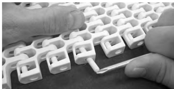
**Figura 293:** Empurre a vareta, passando pela peça de retenção
