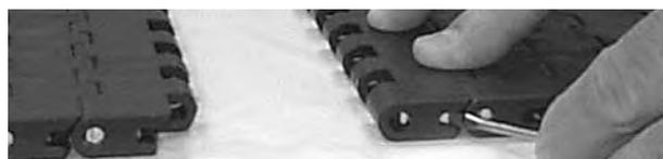
**Figura 161:** Use uma chave de fenda para fechar o Slidelox
