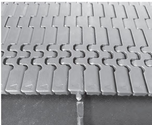
**Figura 60:** Empurre a vareta, passando pela peça de retenção
