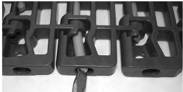
**Figura 120:** Empurre a vareta, passando pela peça de retenção
