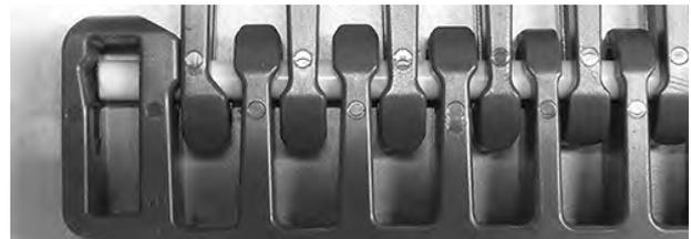
**Figura 337:** Confirme que a vareta passe pela peça de retenção
