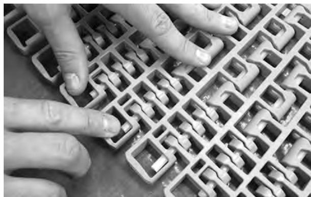
**Figura 344:** Confirme que a vareta passe pela peça de retenção
