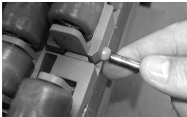
**Figura 191:** Empurre a vareta, passando pela peça de retenção
