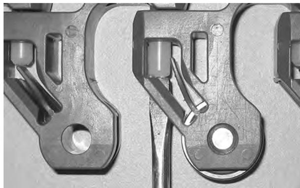
Figura 283: Empurre a vareta, passando pela peça de retenção
