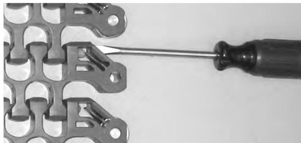
Figura 285: Abra a peça de retenção
