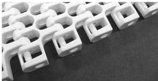
**Figura 294:** Confirme que a vareta passe pela peça de retenção
