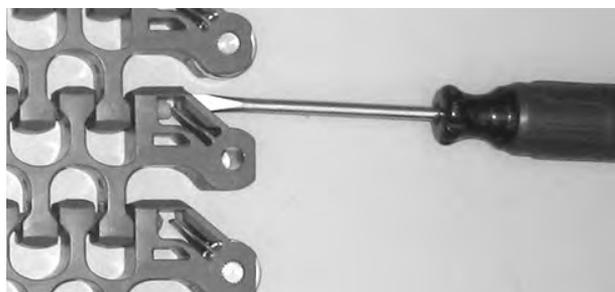
Figura 303: Abra a peça de retenção
