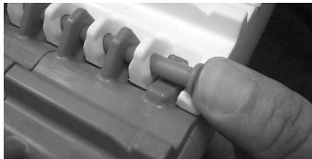
**Figura 78:** Empurre a vareta, passando pela peça de retenção
