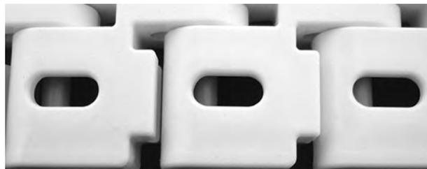
**Figura 289:** Confirme que a vareta passe pela peça de retenção
