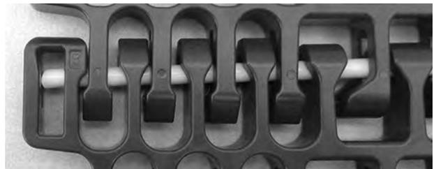
**Figura 320:** Confirme que a vareta passe pela peça de retenção
