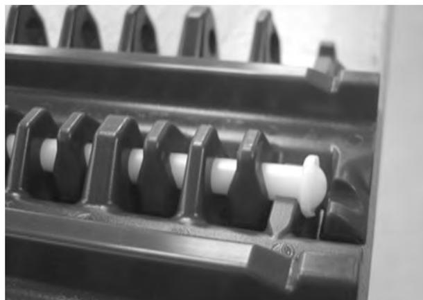
**Figura 71:** Confirme que a vareta passe pela peça de retenção
