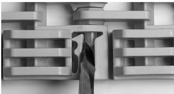
**Figura 86:** Empurre a vareta, passando pela peça de retenção
