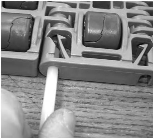
Figura 221: Abra a peça de retenção
