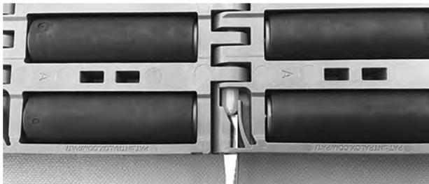
**Figura 242:** Empurre a vareta, passando pela peça de retenção
