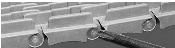
**Figura 29:** Confirme que a cabeça da haste esteja além do travamento por pressão
