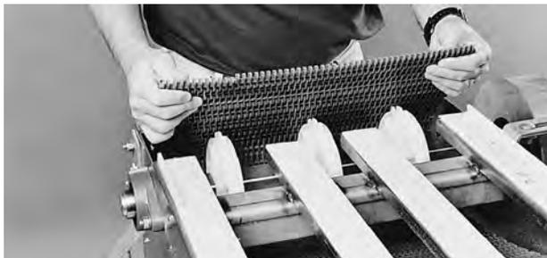
**Figura 17:** Retorno inferior da esteira de alimentação
