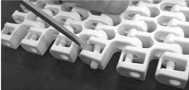
**Figura 295:** Empurre a vareta através da peça de retenção
