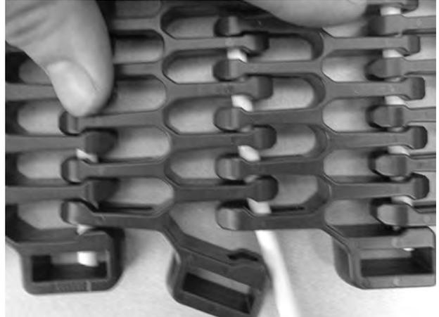
Abbildung 329: Ausrichten der Scharniere
