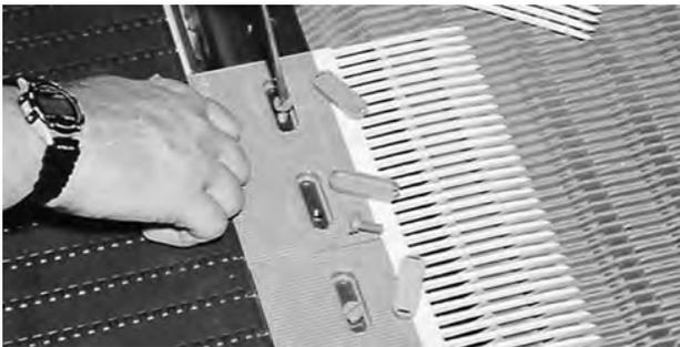
**Abbildung 24:** Montage der Fingerübergabeplatten mit Intralox-Kunststoffschrauben
