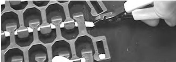
**Abbildung 316:** Ergreifen des Scharnierstabes
