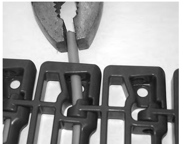
**Abbildung 123:** Ziehen des Scharnierstabes aus dem Band
