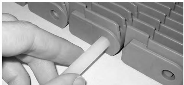
**Abbildung 219:** Ziehen des Scharnierstabes aus dem Band
