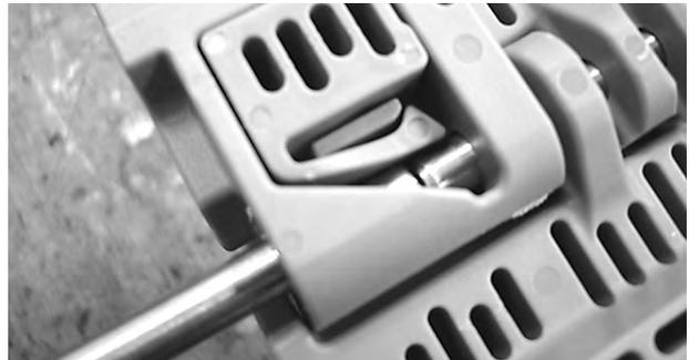
**Abbildung 100:** Scharnierstab am Verschlussystem vorbei schieben
