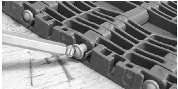
Abbildung 272: Vorbeischieben des Rodlets am Verschlussystem
