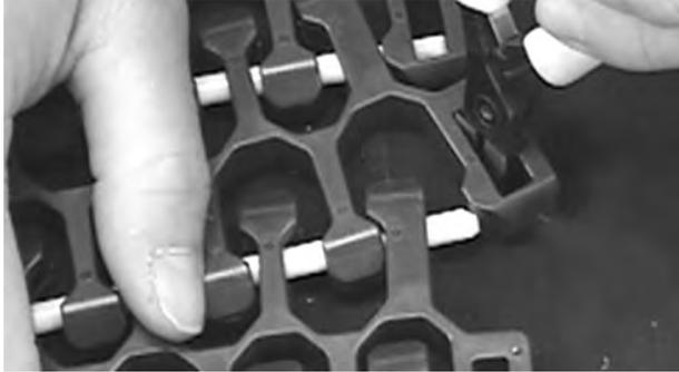
**Abbildung 315:** Biegen der bündigen Kante des Moduls zum Lösen des Scharnierstabes
