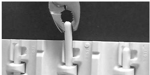
**Abbildung 208:** Ziehen des Scharnierstabes aus dem Band
