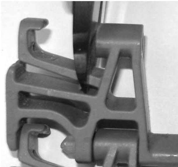
**Abbildung 257:** Abschneiden des Verschlussystems
