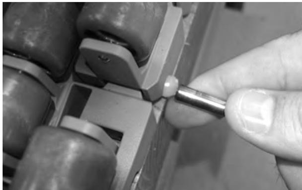
Abbildung 191: Scharnierstab am Verschlussystem vorbei schieben
