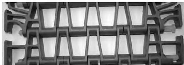
**Abbildung 260:** Scharnierstab muss Verschlussystem überragen
