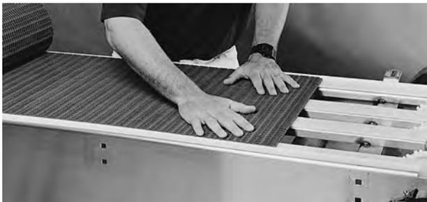
Abbildung 14: Verlegung des Bandes am Antriebsende
