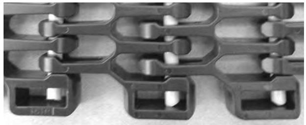
Abbildung 331: Scharnierstab muss vollständig eingeführt sein
