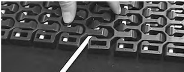
Abbildung 309: Führen des Scharnierstabes durch Scharniere
