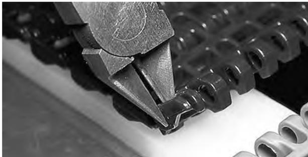
**Abbildung 141:** Abschneiden der Hälfte der Kante
