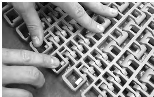
Abbildung 344: Scharnierstab muss Verschlussystem überragen
