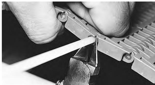
**Abbildung 109:** Abschneiden des Scharnierstabes bündig zur Bandkante
