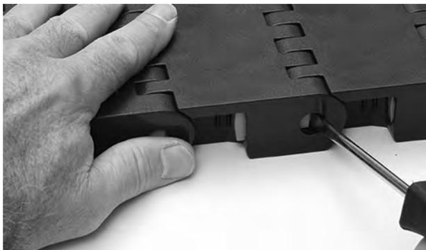
Abbildung 265: Öffnen des Slidelox
