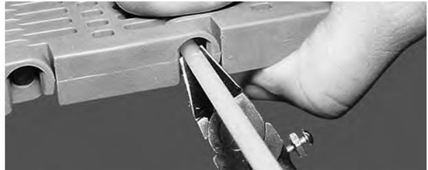
**Abbildung 45:** Abschneiden des Scharnierstabes bündig zur Bandkante
