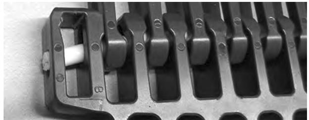
Abbildung 336: Führen des Scharnierstabes durch Scharniere
