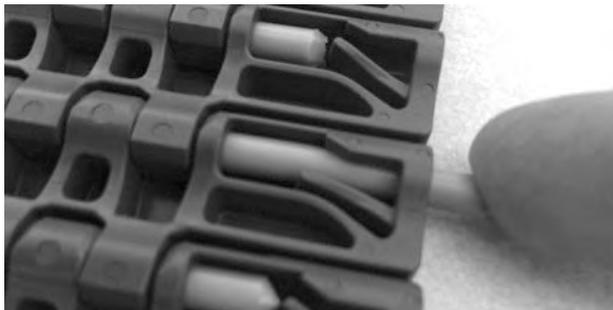
**Abbildung 128:** Einführen des Scharnierstabes durch das Scharnier
