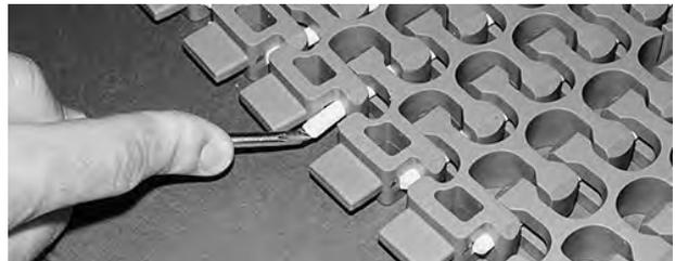
Abbildung 276: Scharnierstab muss Verschlussystem überragen
