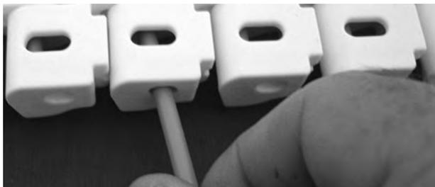
**Abbildung 287:** Führen des Scharnierstabes durch Scharniere
