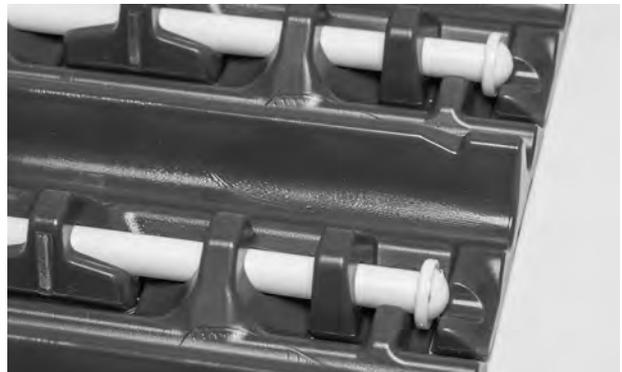
**Abbildung 95:** Scharnierstab muss Verschlussystem überragen
