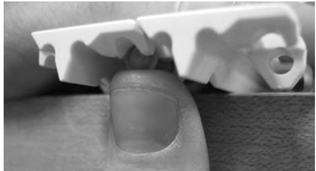
**Abbildung 181:** Scharnierstab am Verschlussystem vorbei schieben
