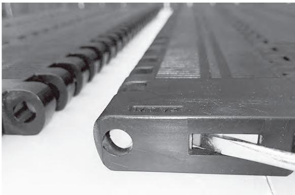
Abbildung 210: Schließen des Slidelox mit einem Schraubendreher
