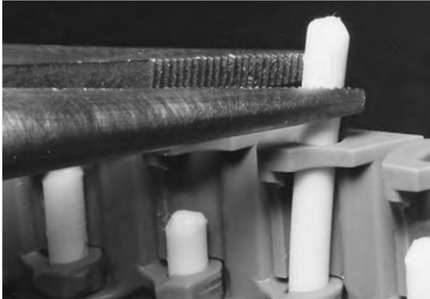
Abbildung 150: Ziehen des Scharnierstabes aus dem Band
