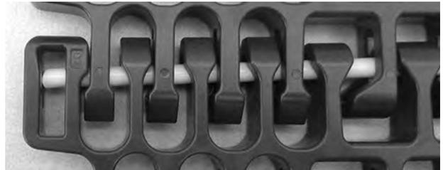
**Abbildung 320:** Scharnierstab muss Verschlussystem überragen
