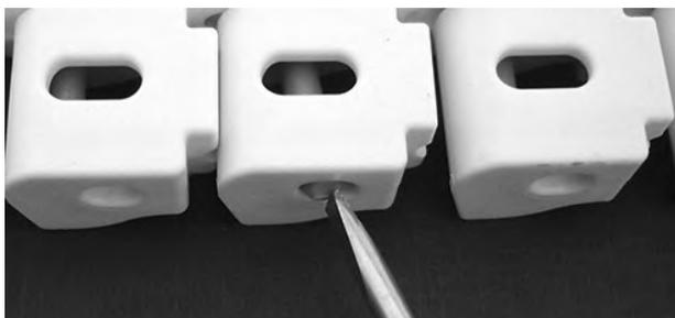
**Abbildung 288:** Scharnierstab am Verschlussystem vorbei schieben
