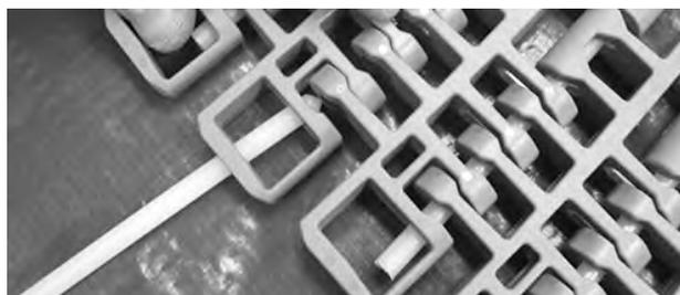
Abbildung 342: Führen des Scharnierstabes durch Scharniere
