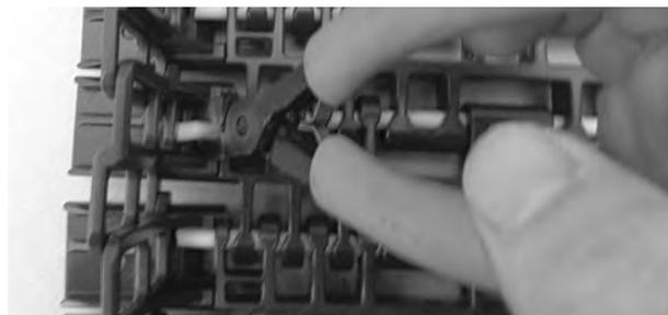
Abbildung 358: Ziehen des Scharnierstabes aus dem Band
