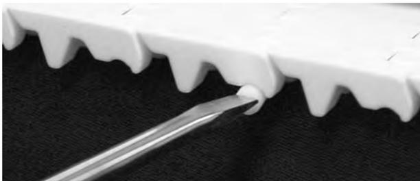
**Abbildung 175:** Scharnierstab am Verschlussystem vorbei schieben
