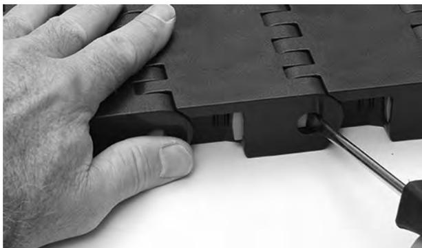
**Abbildung 262:** Öffnen des Slidelox
