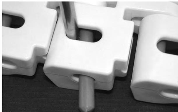
**Abbildung 290:** Vorbeischieben des Scharnierstabes am Verschlussystem
