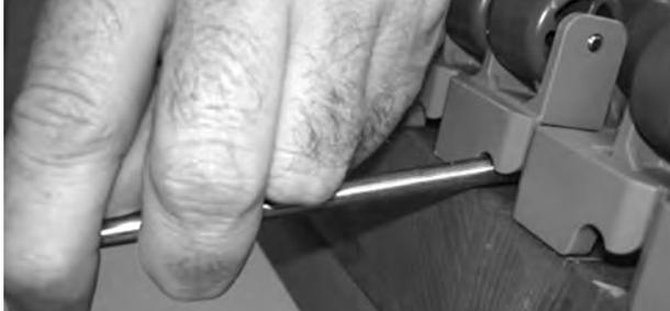
**Abbildung 194:** Einführen des Stahl-Verbindungsstifts in das Scharnier
