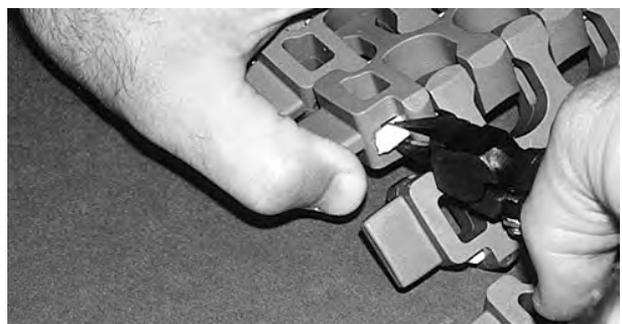
Abbildung 278: Lösen des Scharnierstabes aus dem Verschlussystem
