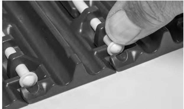
**Abbildung 94:** Scharnierstab am Verschlussystem vorbei schieben
