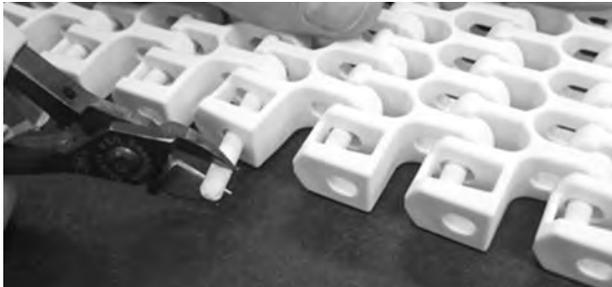
**Abbildung 296:** Ziehen des Scharnierstabes aus dem Band
