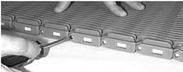
**Abbildung 49:** Öffnen des Slidelox
