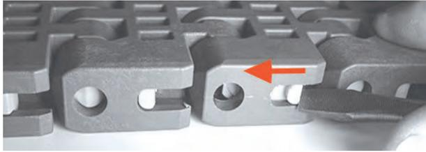
Abbildung 159: Schließen des Slidelox
