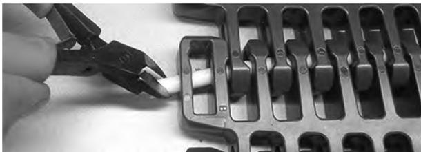
**Abbildung 339:** Ziehen des Scharnierstabes aus dem Band
