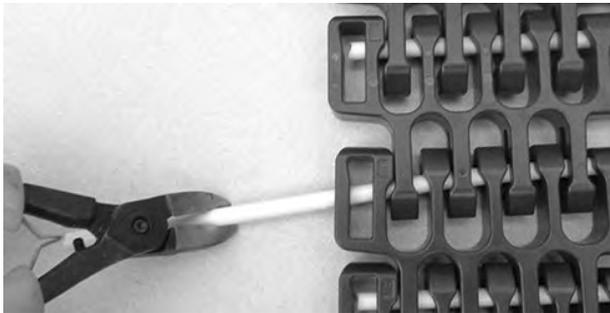
**Abbildung 322:** Ziehen des Scharnierstabes aus dem Band
