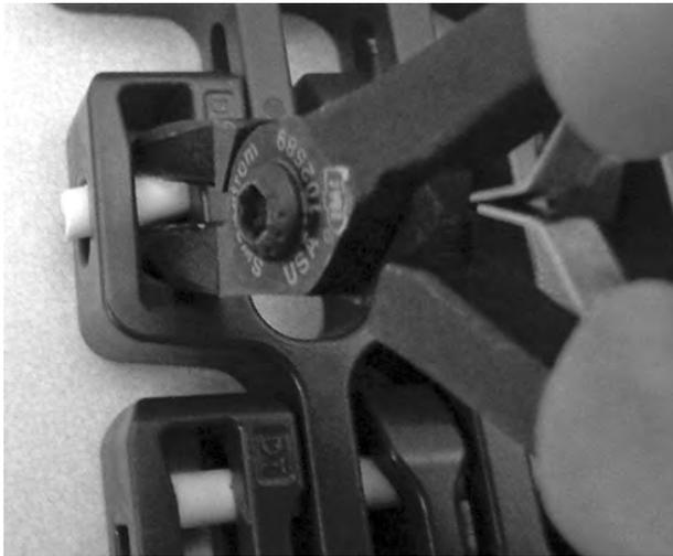
**Abbildung 321:** Beiseiteschieben des Scharnierstabes über die Bohrung hinaus
