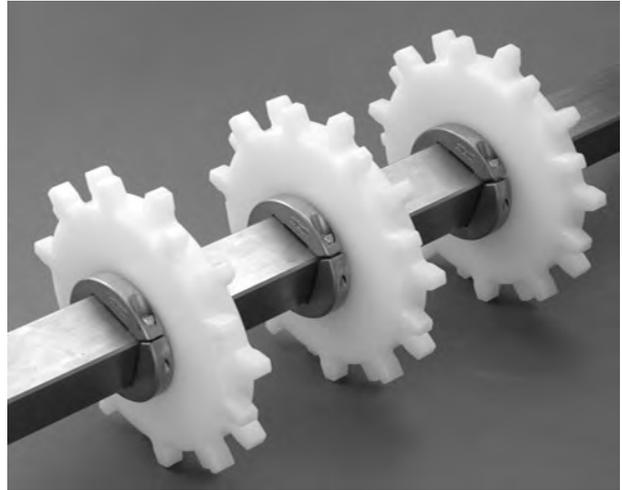
**Abbildung 340:** Beidseitiges Sichern aller Zahnräder
