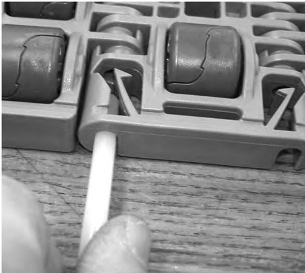
**Abbildung 221:** Öffnen des Verschlussystems
