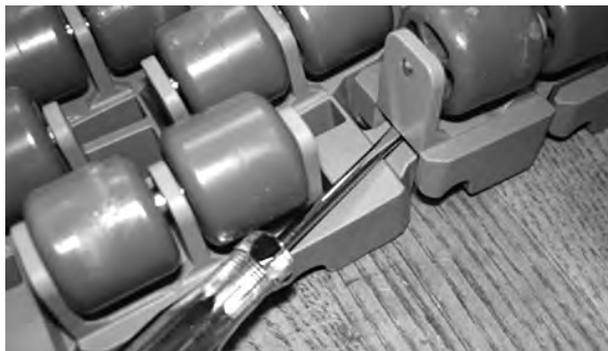
Abbildung 193: Einsetzen des Schraubendrehers unter der Rolle
