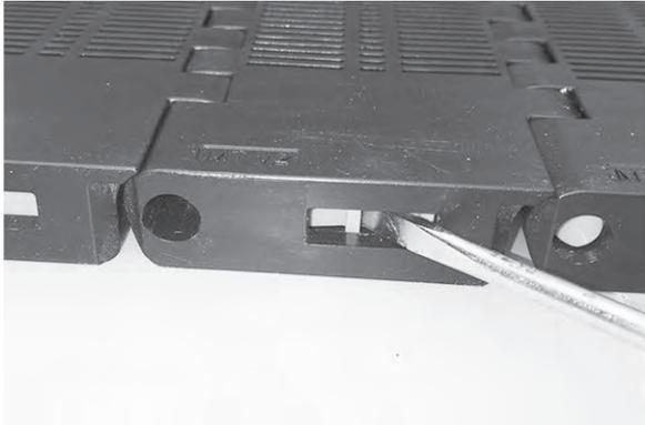
**Abbildung 213:** Öffnen des Slidelox
