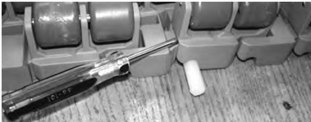
**Abbildung 196:** Ziehen des Scharnierstabes aus dem Band
