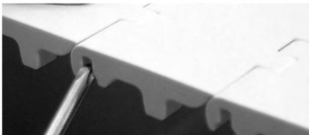
**Abbildung 205:** Vorbeischieben des Scharnierstabes am Verschlussystem
