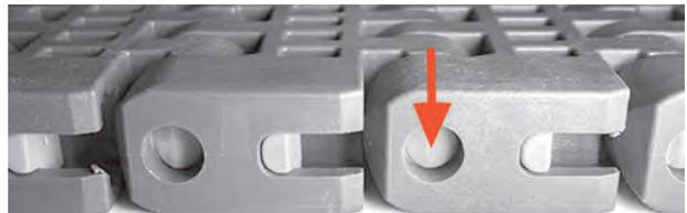
Abbildung 158: Öffnen des Slidelox
