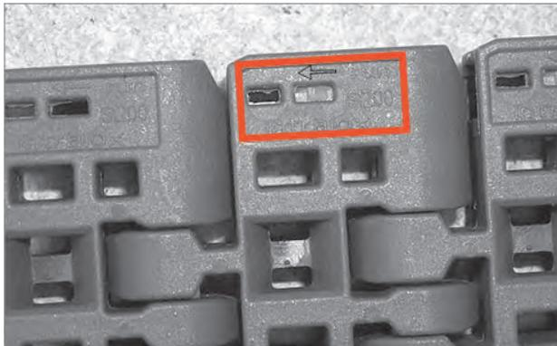
Abbildung 155: Bandlaufrichtung
