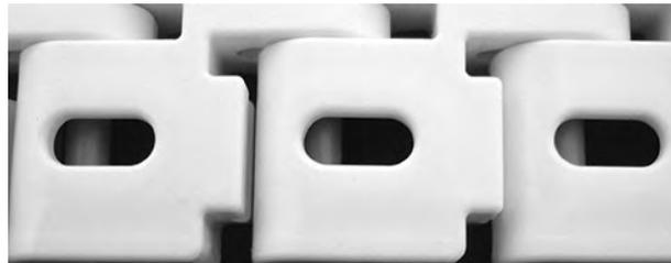
**Abbildung 289:** Scharnierstab muss Verschlussystem überragen
