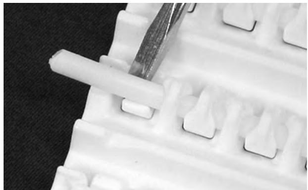
**Abbildung 177:** Heben des Scharnierstabes über das Verschlussystem
