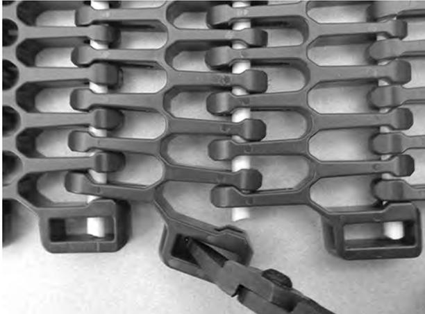
Abbildung 332: Biegen der bündigen Kante des Moduls
