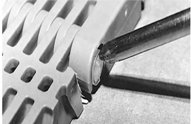
**Abbildung 54:** Vorbeischieben des Scharnierstabes am Verschlusssystem
