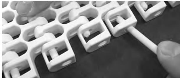
**Abbildung 292:** Führen des Scharnierstabes durch Scharniere
