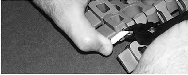
**Abbildung 279:** Ergreifen des Scharnierstabes
