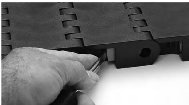
**Abbildung 261:** Schließen des Slidelox
