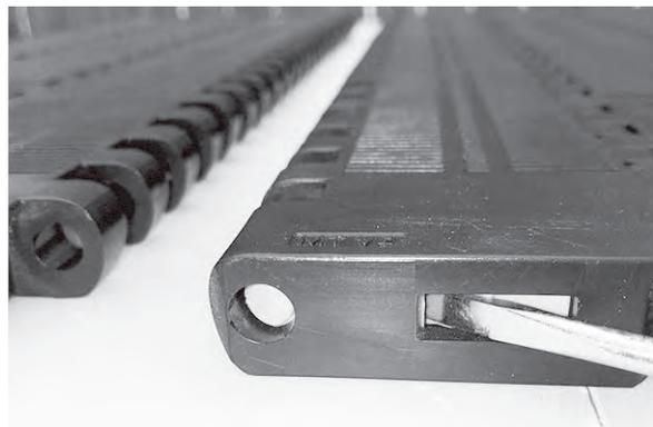
Abbildung 212: Schließen des Slidelox
