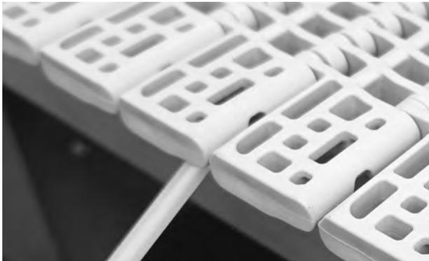
**Abbildung 124:** Scharnierstab unter bündiger Kante einführen
