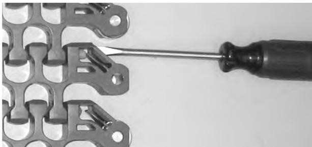
Abbildung 303: Öffnen des Verschlussystems
