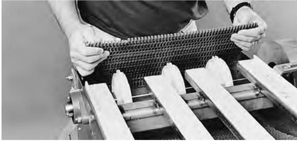
Abbildung 17: Verlegen des Bandes am Untertrum
