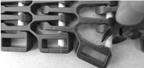
Abbildung 333: Ergreifen des Scharnierstabes
