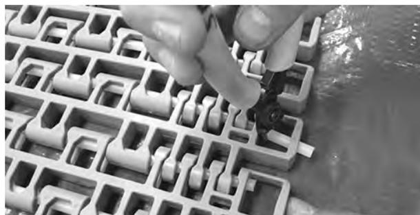
Abbildung 345: Ziehen des Scharnierstabes aus dem Band
