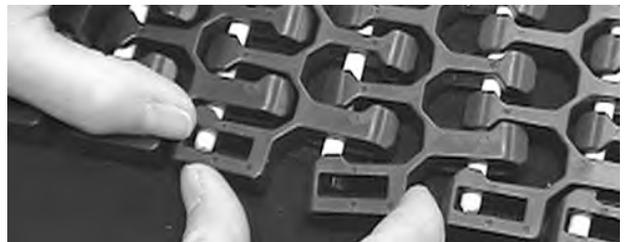
Abbildung 312: Einschieben des Scharnierstabes über die Bandkante hinaus, Einrasten der bündigen Kante über dem Scharnierstab
