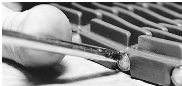
**Abbildung 108:** Scharnierstab muss Schnappverschluss überragen
