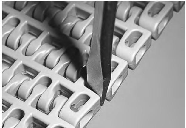
**Abbildung 139:** Scharnierstab am Verschlussystem vorbei schieben
