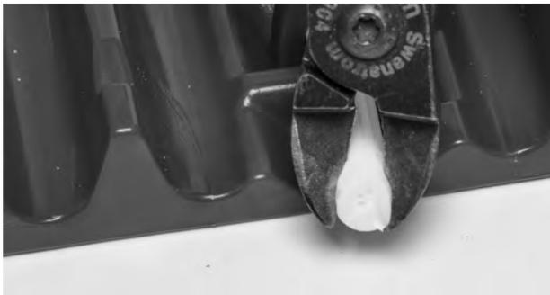
**Abbildung 97:** Ziehen des Scharnierstabes aus dem Band
