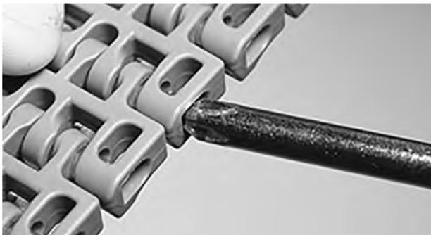
**Abbildung 137:** Scharnierstab am Verschlussystem vorbei schieben
