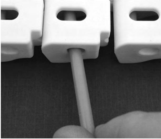
**Abbildung 291:** Ziehen des Scharnierstabes aus dem Band
