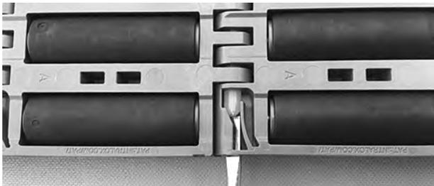
Abbildung 242: Scharnierstab am Verschlussystem vorbei schieben
