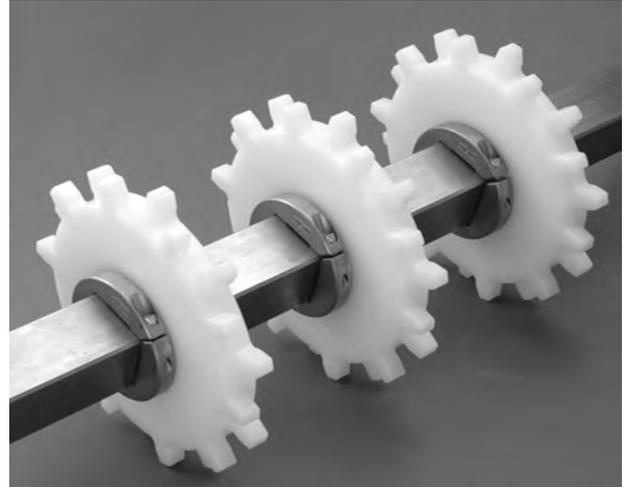
**Abbildung 323:** Beidseitiges Sichern aller Zahnräder
