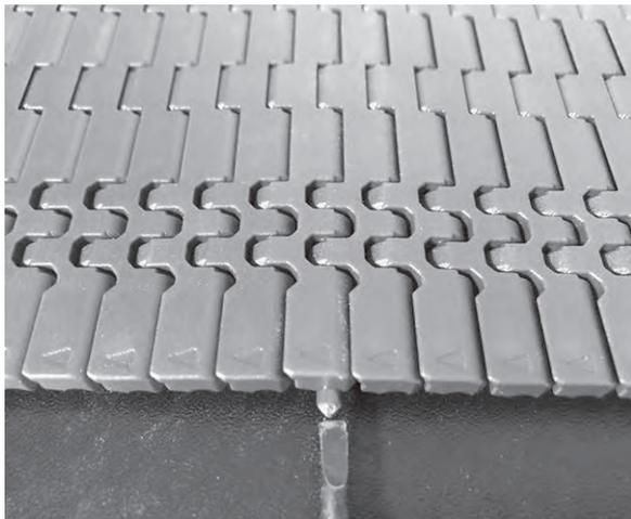
**Abbildung 60:** Scharnierstab am Verschlussystem vorbei schieben
