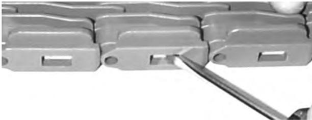
**Abbildung 48:** Schließen des Slidelox
