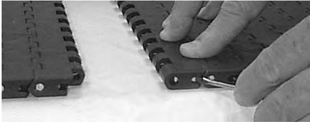
Abbildung 163: Schließen des Slidelox
