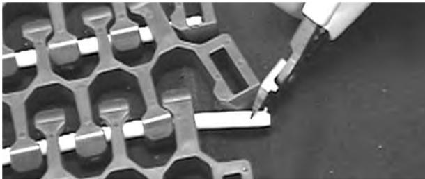
**Abbildung 317:** Ziehen des Scharnierstabes aus dem Band
