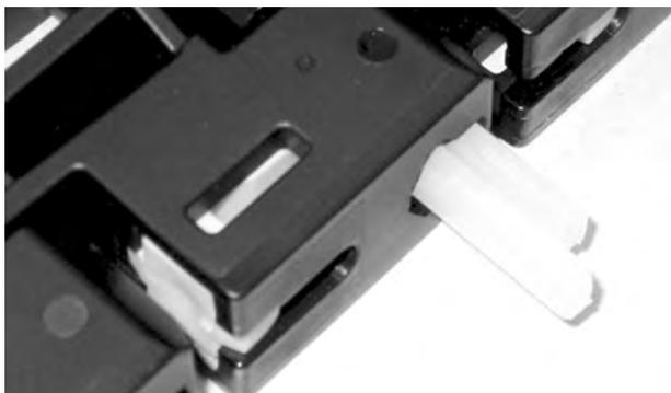
**Abbildung 186:** Führen des Scharnierstabes durch Scharniere
