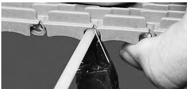
Abbildung 30: Abschneiden des Scharnierstabes bündig zur Bandkante
