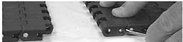
Abbildung 161: Schließen des Slidelox mit einem Schraubendreher
