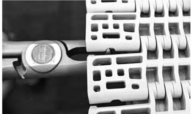
**Abbildung 126:** Scharnierstabwerkzeug zum Greifen des Scharnierstabs verwenden
