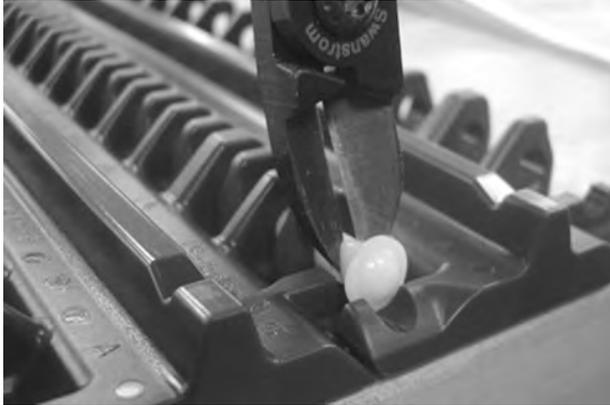
Abbildung 72: Abschneiden des Scharnierstabes
