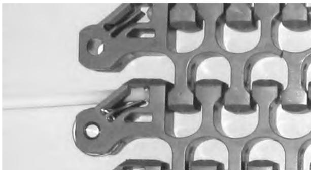
Abbildung 304: Ziehen des Scharnierstabes aus dem Band
