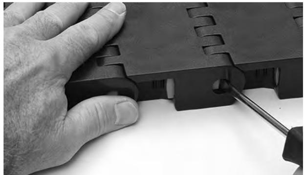
Abbildung 267: Öffnen des Slidelox
