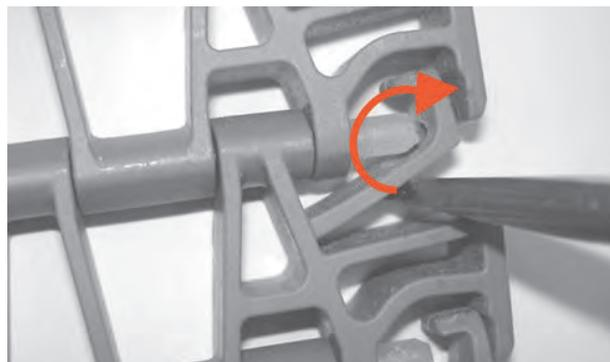
**Abbildung 254:** Verdrehen des Schraubendrehers, um das Verschlussystem offen zu halten
