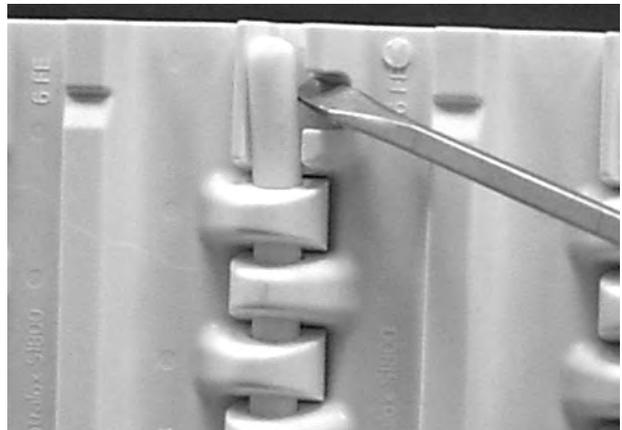
**Abbildung 207:** Heben des Scharnierstabes über das Verschlussystem
