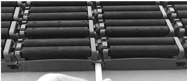
Abbildung 241: Führen des Scharnierstabes durch Scharniere
