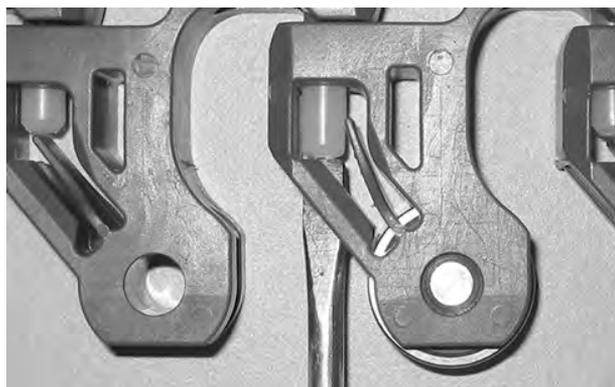
Abbildung 283: Scharnierstab am Verschlussystem vorbei schieben
