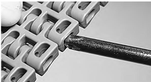
**Abbildung 146:** Scharnierstab am Verschlussystem vorbei schieben
