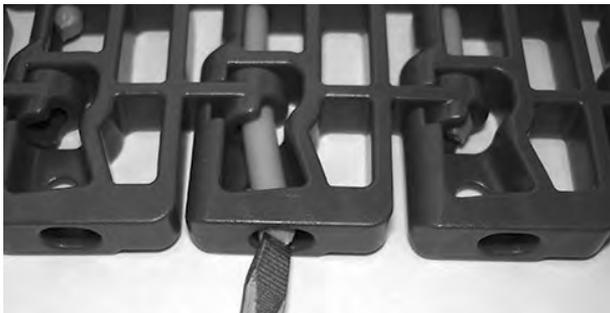
**Abbildung 120:** Scharnierstab am Verschlussystem vorbei schieben
