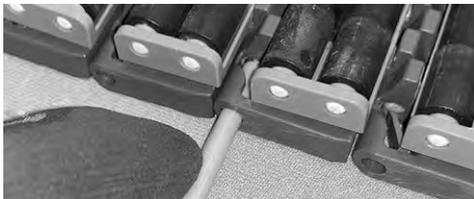
**Abbildung 247:** Führen des Scharnierstabes durch Scharniere
