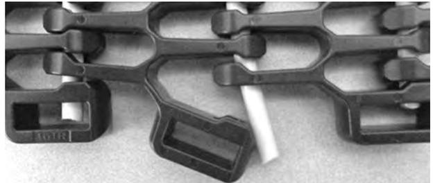
Abbildung 330: Hinausschieben des Scharnierstabes über die Bandkante
