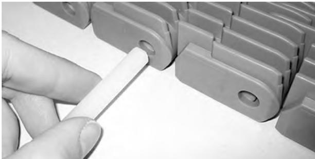
**Abbildung 216:** Führen des Scharnierstabes durch Scharniere
