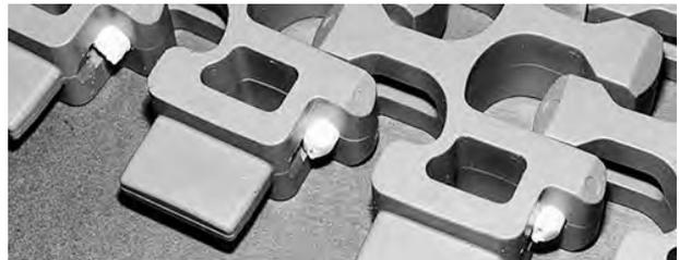
Abbildung 277: Scharnierstab muss vollständig eingeführt sein
