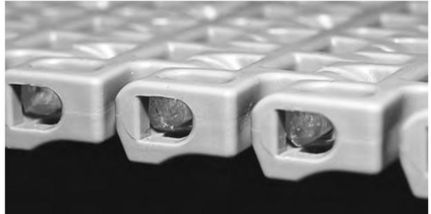
**Abbildung 138:** Scharnierstab muss Verschlussystem überragen
