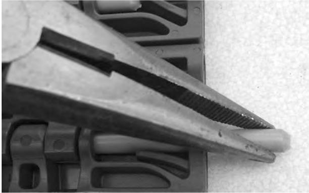
**Abbildung 132:** Ziehen des Scharnierstabes aus dem Band
