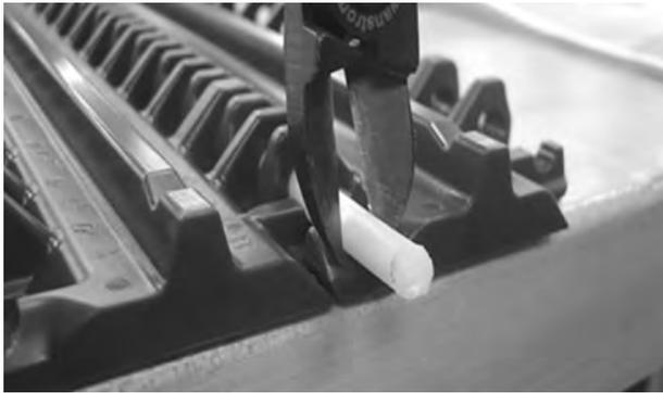
Abbildung 73: Ziehen des Scharnierstabes aus dem Band
