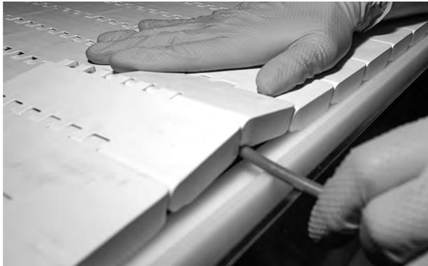
**Abbildung 89:** Leichtes Biegen und Einführen des Scharnierstabes durch die Scharniere
