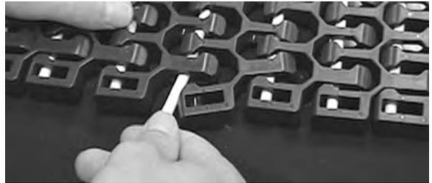
Abbildung 311: Führen des Scharnierstabes durch Scharniere
