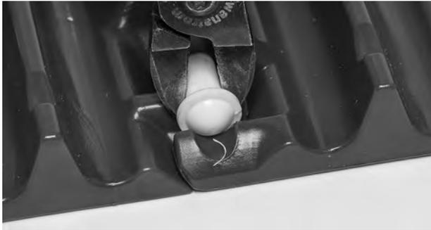
**Abbildung 96:** Abschneiden des Scharnierstabes
