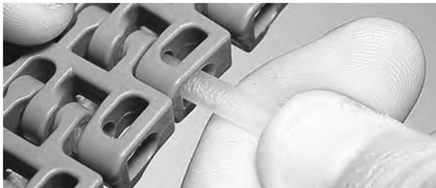
**Abbildung 145:** Führen des Scharnierstabes durch Scharniere
