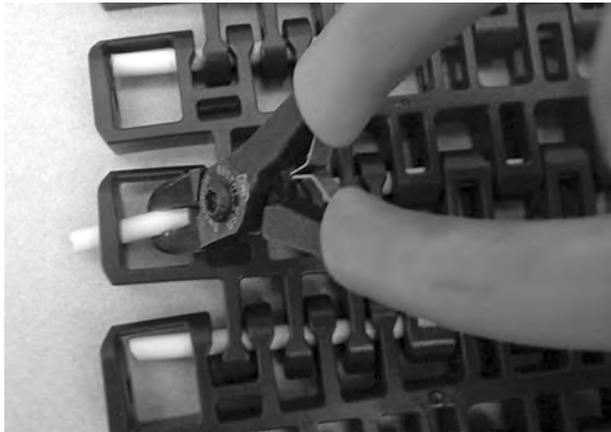
**Abbildung 362:** Scharnierstab am Verschlusssystem vorbei schieben
