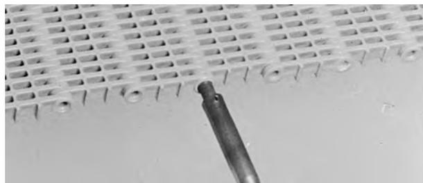
Abbildung 36: Verschließen der Scharnierstaböffnung
