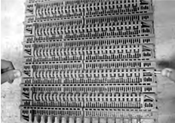
Abbildung 102: Ziehen des Scharnierstabes aus dem Band
