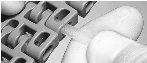
**Abbildung 136:** Führen des Scharnierstabes durch Scharniere
