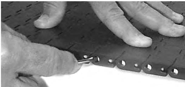
Abbildung 164: Öffnen des Slidelox
