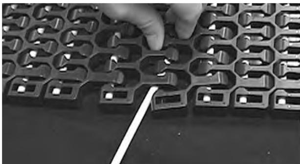
Abbildung 310: Ausrichten der Scharniere
