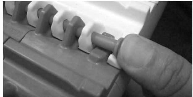
**Abbildung 78:** Scharnierstab am Verschlussystem vorbei schieben
