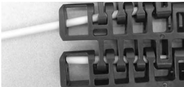
Abbildung 359: Führen des Scharnierstabes durch Scharniere
