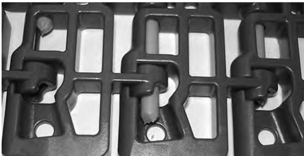
**Abbildung 121:** Scharnierstab muss vollständig eingeführt sein
