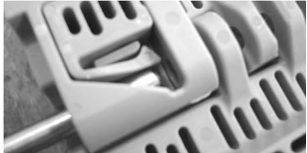
**Abbildung 99:** Führen des Scharnierstabes durch Scharniere
