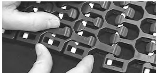
Abbildung 313: Scharnierstab muss vollständig eingesetzt sein
