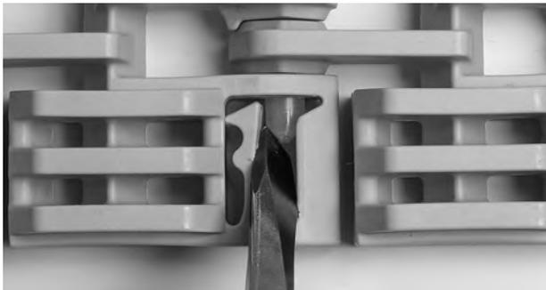
**Abbildung 86:** Scharnierstab am Verschlussystem vorbei schieben
