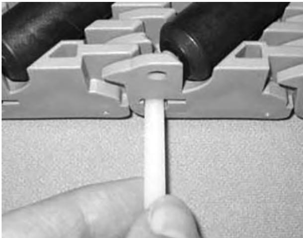
**Abbildung 231:** Führen des Scharnierstabes durch Scharniere
