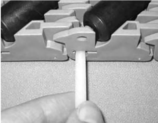
Abbildung 225: Führen des Scharnierstabes durch Scharniere
