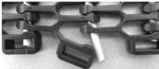
**Figura 330:** Empujar la varilla hasta que pase más allá del borde de la banda
