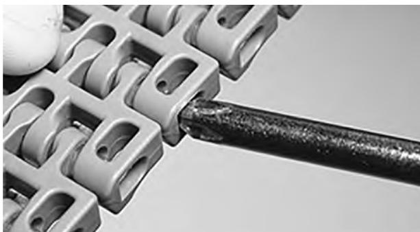
**Figura 146:** Inserte la varilla hasta pasar el sistema de retención
