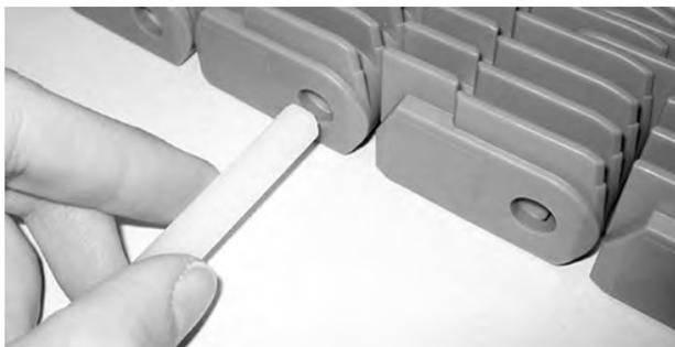
**Figura 216:** Insertar la varilla en las bisagras
