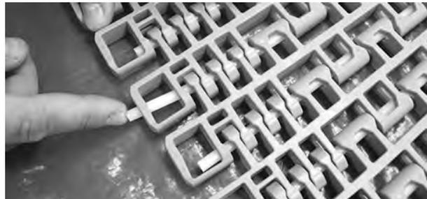
Figura 343: Inserte la varilla hasta pasar el sistema de retención
