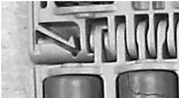
**Figura 224:** Asegurarse de que la varilla pasa más allá del sistema de retención
