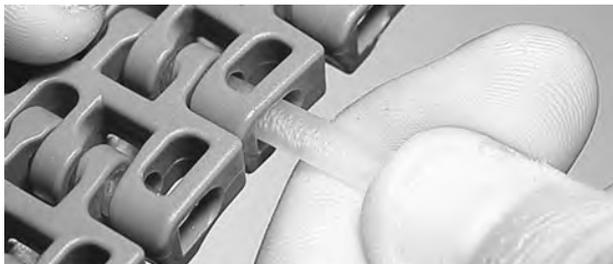
**Figura 136:** Insertar la varilla en las bisagras
