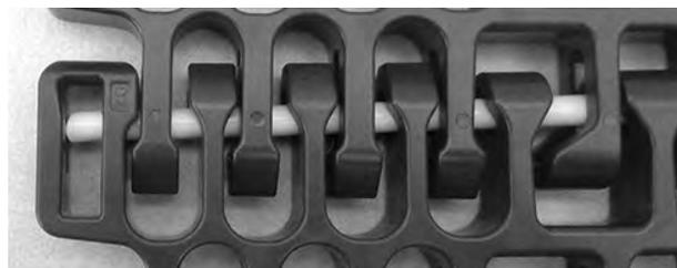
**Figura 320:** Asegurarse de que la varilla pasa más allá del sistema de retención
