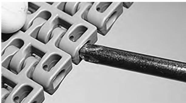
**Figura 137:** Inserte la varilla hasta pasar el sistema de retención
