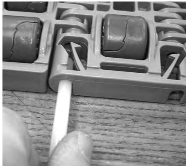
Figura 221: Abrir el sistema de retención
