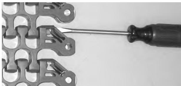
Figura 303: Abrir el sistema de retención
