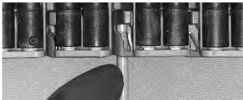
**Figura 248:** Introduzca la varilla hasta rebasar el sistema de retención
