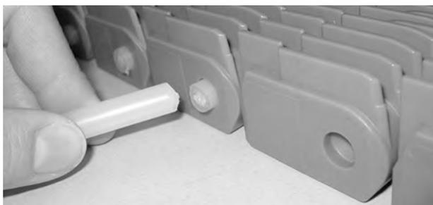
**Figura 217:** Empujar la varilla a través del Shuttleplug
