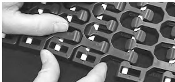
**Figura 313:** Asegurarse de que la varilla esté totalmente introducida
