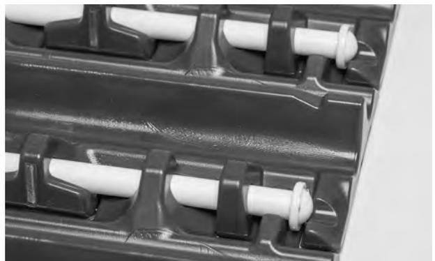
**Figura 95:** Asegurarse de que la varilla pasa más allá del sistema de retención
