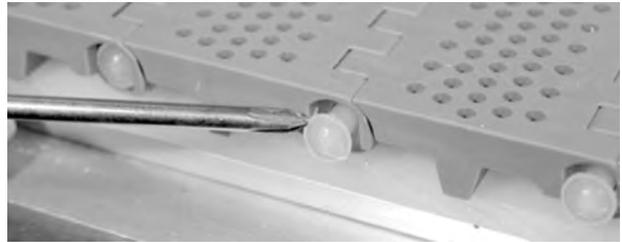
**Figura 64:** Insertar la varilla en la banda
