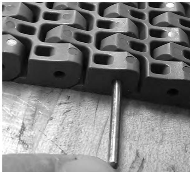
**Figura 274:** Sacar la varilla y la varillita de la banda
