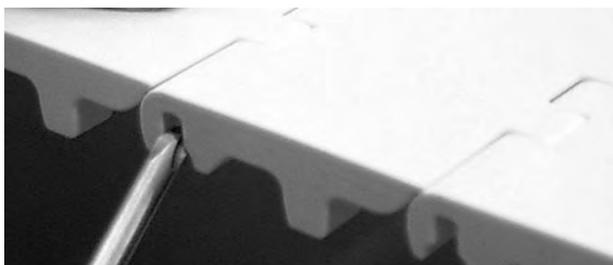
**Figura 205:** Empujar la varilla a través del sistema de retención
