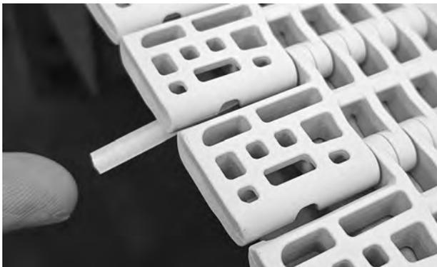
**Figura 125:** Empujar la varilla hasta que encaje en el borde
