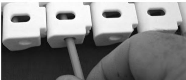
**Figura 287:** Insertar la varilla en las bisagras
