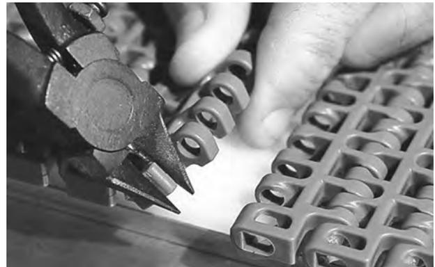
**Figura 153:** Cortar el borde de la banda
