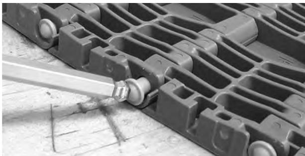
**Figura 272:** Empujar la varillita a través del sistema de retención
