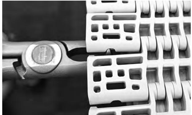
**Figura 126:** Usar el extractor de varillas para sujetar la varilla
