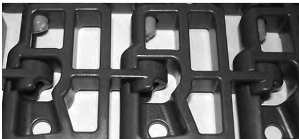
**Figura 112:** Las varillas se adentran en el borde al ras
