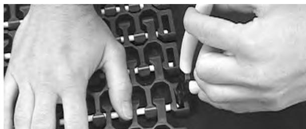
**Figura 314:** Insertar la varilla en la banda
