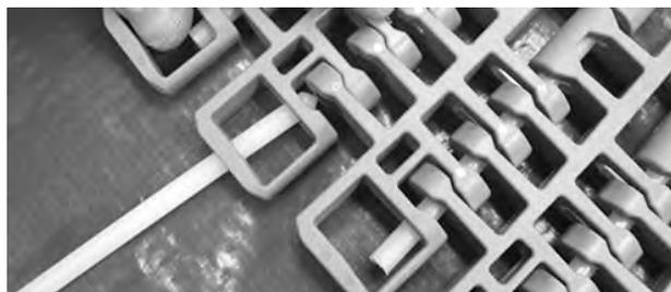
Figura 342: Insertar la varilla en las bisagras
