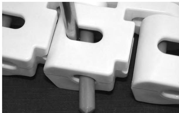
**Figura 290:** Empujar la varilla a través del sistema de retención
