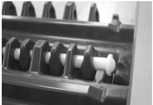
**Figura 71:** Asegurarse de que la varilla pasa más allá del sistema de retención
