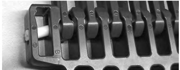
**Figura 336:** Insertar la varilla en las bisagras
