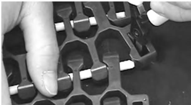
**Figura 315:** Doblar el borde al ras del módulo hasta liberar la varilla
