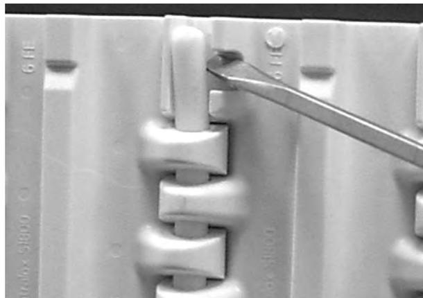
**Figura 207:** Levantar la varilla por encima del sistema de retención
