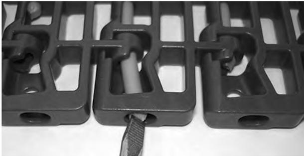
**Figura 120:** Inserte la varilla hasta pasar el sistema de retención
