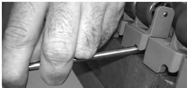
**Figura 194:** Insertar la espiga de acero en la bisagra
