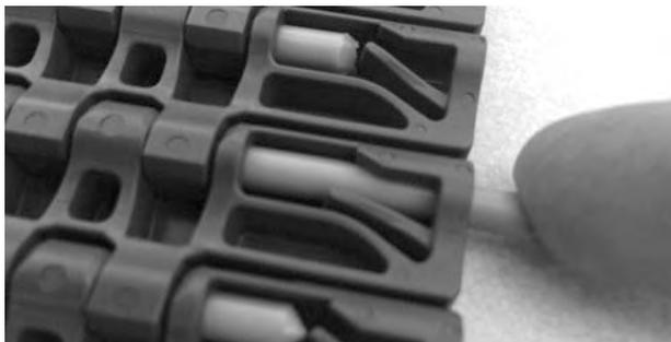
**Figura 128:** Insertar la varilla en las bisagras
