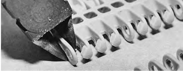
**Figura 32:** Cortar el eslabón más externo
