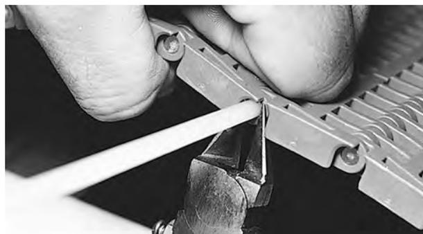
**Figura 109:** Cortar la varilla al ras con el borde de la banda
