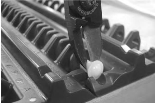
Figura 72: Cortar la cabeza de la varilla
