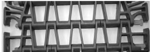
**Figura 260:** Asegurarse de que la varilla pasa más allá del sistema de retención
