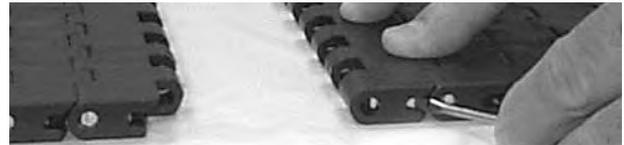
**Figura 161:** Utilizar un destornillador para cerrar el Slidelox
