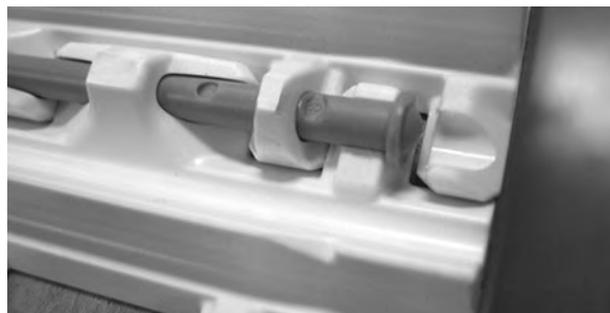
**Figura 182:** Asegurarse de que la varilla esté totalmente introducida
