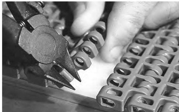
**Figura 143:** Cortar el borde de la banda
