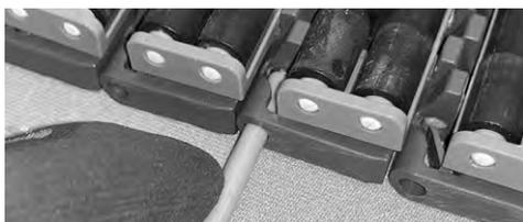
**Figura 247:** Insertar la varilla en las bisagras
