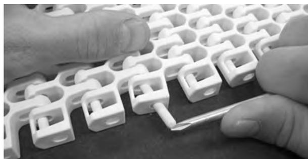
**Figura 293:** Inserte la varilla hasta pasar el sistema de retención
