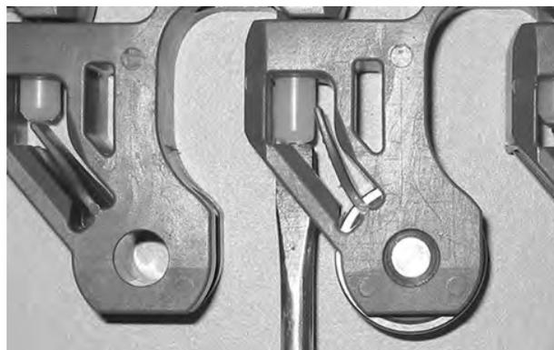
Figura 305: Inserte la varilla hasta pasar el sistema de retención
