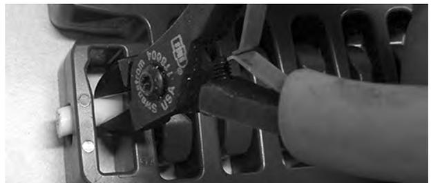
**Figura 338:** Empujar la varilla hacia el costado y más allá del orificio ocluido
