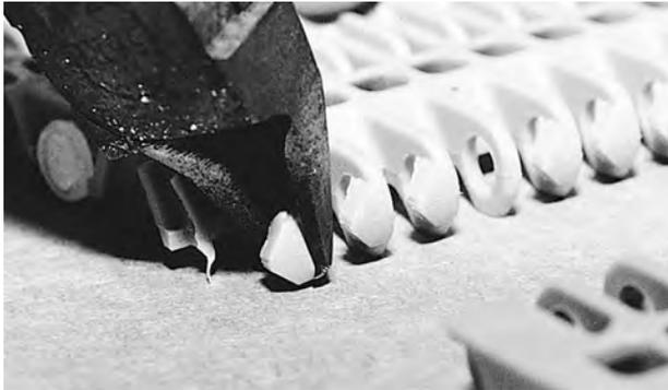
**Figura 33:** Cortar la punta del separador
