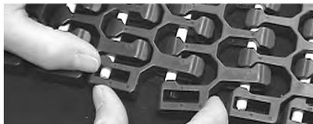
**Figura 312:** Empujar la varilla hasta que pase más allá del borde de la banda y enganchar a presión el borde al ras por encima de la varilla
