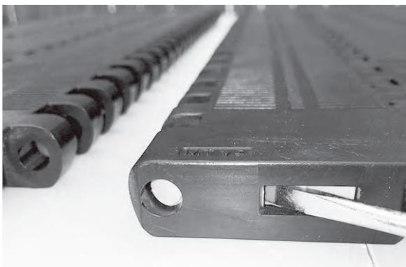
Figura 210: Utilizar un destornillador para cerrar el Slidelox
