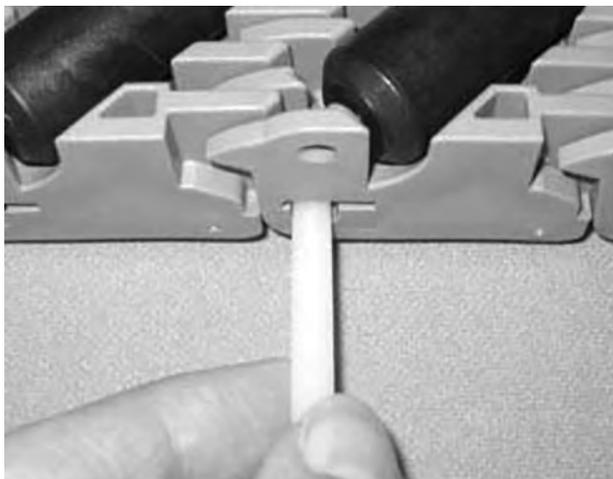
**Figura 231:** Insertar la varilla en las bisagras
