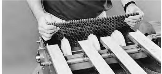
**Figura 17:** Introducir la banda por el recorrido de retorno
