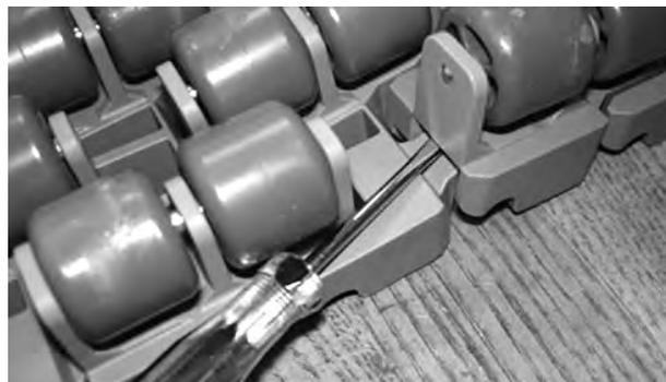
Figura 193: Introducir el destornillador bajo el rodillo
