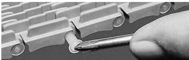
Figura 28: Insertar la varilla en la banda
