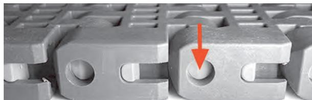
Figura 156: Asegurarse de que el Slidelox está abierto
