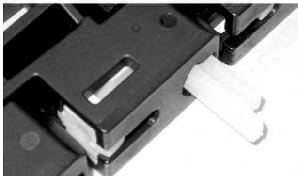
**Figura 186:** Insertar la varilla en las bisagras
