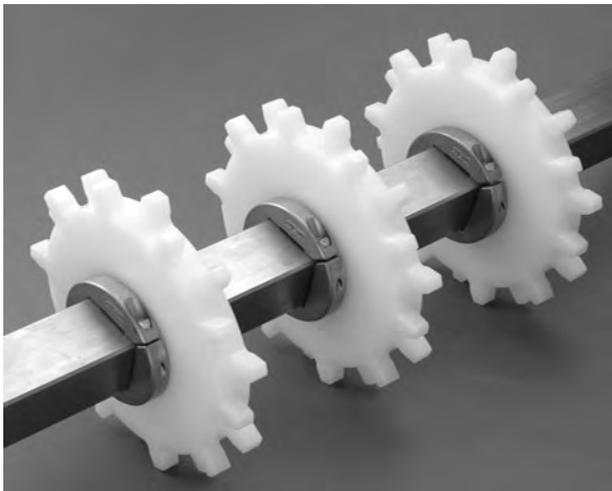
**Figura 340:** Fijar los dos lados de todos los engranajes
