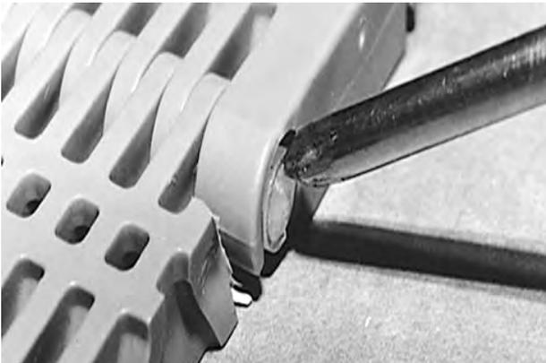
**Figura 54:** Empujar la varilla a través del sistema de retención
