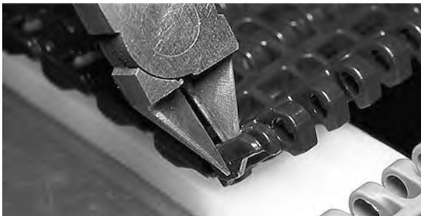
**Figura 151:** Cortar el elemento de borde
