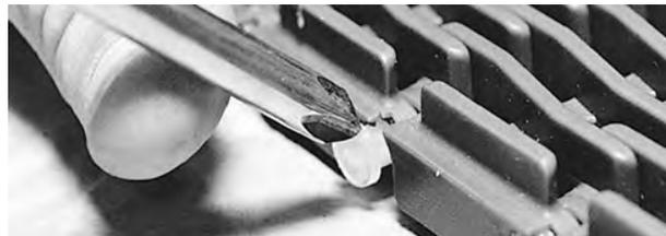
**Figura 107:** Insertar la varilla en la banda
