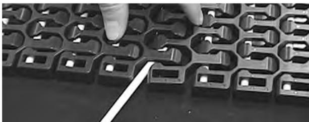
**Figura 309:** Insertar la varilla en las bisagras
