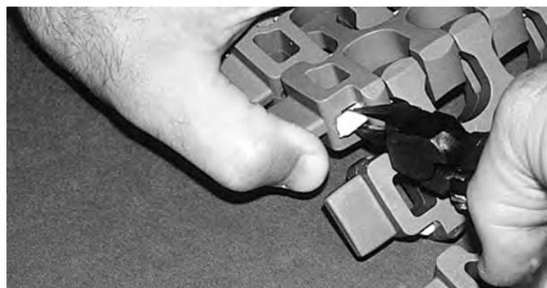
Figura 278: Soltar la varilla del sistema de retención
