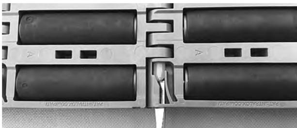
**Figura 242:** Inserte la varilla hasta pasar el sistema de retención
