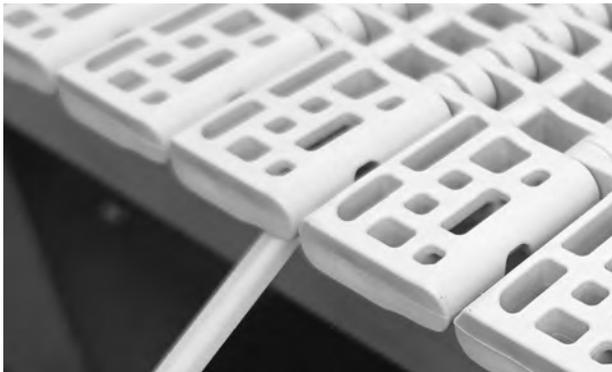
**Figura 124:** Introducir la varilla por debajo del borde
