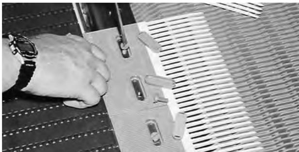
**Figura 24:** Instalar las placas de uñeta de transferencia con pernos de plástico de Intralox
