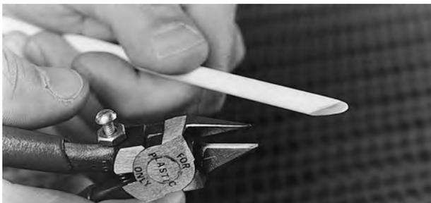
**Figura 20:** Recortar la varilla en ángulo
