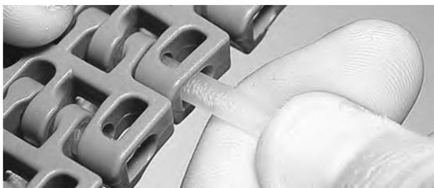
**Figura 145:** Insertar la varilla en las bisagras
