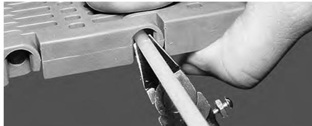
**Figura 45:** Cortar la varilla al ras con el borde de la banda
