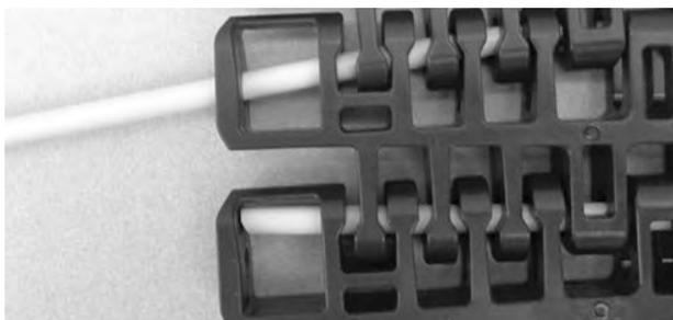
**Figura 359:** Insertar la varilla en las bisagras
