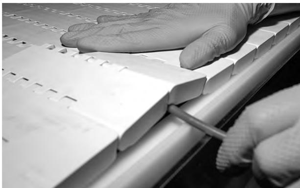
**Figura 89:** Doblar ligeramente e insertar la varilla en las bisagras
