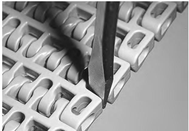
**Figura 139:** Inserte la varilla hasta pasar el sistema de retención
