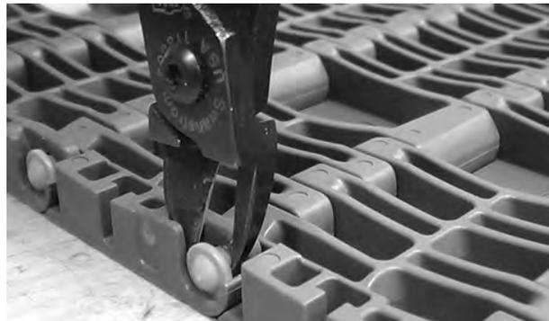
**Figura 273:** Cortar la varillita
