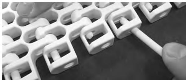
**Figura 292:** Insertar la varilla en las bisagras
