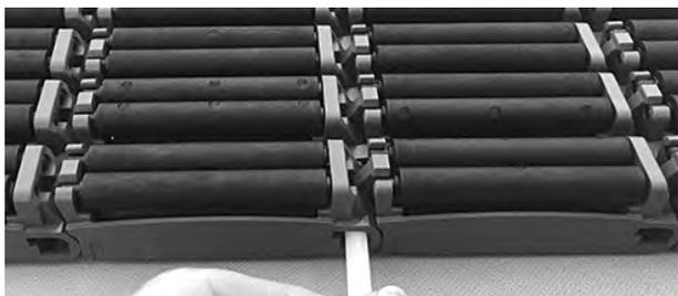
**Figura 241:** Insertar la varilla en las bisagras
