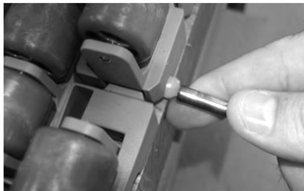
Figura 191: Inserte la varilla hasta pasar el sistema de retención
