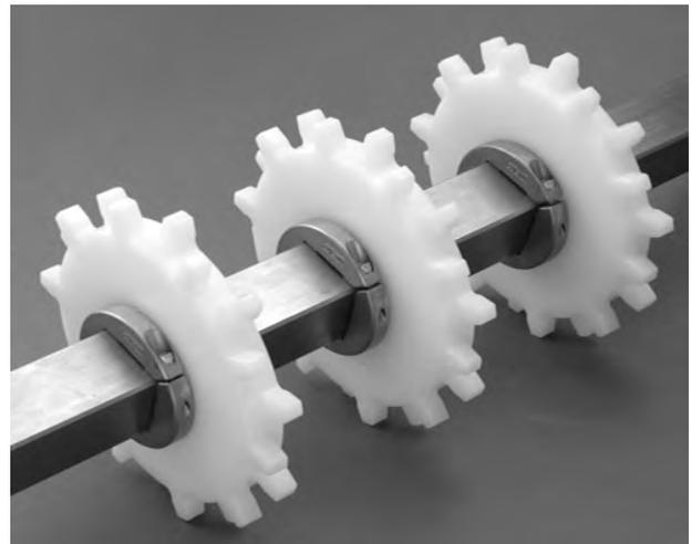
**Figura 323:** Fijar los dos lados de todos los engranajes
