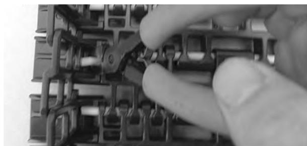
**Figura 372:** Inserte la varilla hasta pasar el sistema de retención
