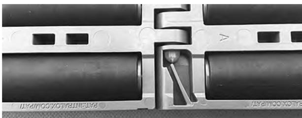
**Figura 243:** Asegurarse de que la varilla pasa más allá del sistema de retención
