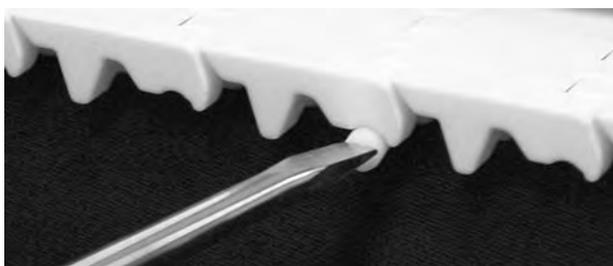
**Figura 175:** Inserte la varilla hasta pasar el sistema de retención
