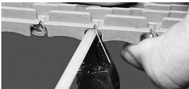
Figura 30: Cortar la varilla al ras con el borde de la banda
