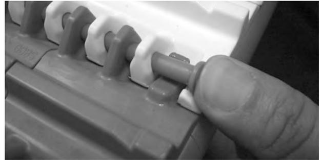
**Figura 78:** Inserte la varilla hasta pasar el sistema de retención
