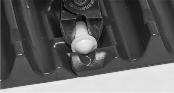
**Figura 96:** Cortar la cabeza de la varilla
