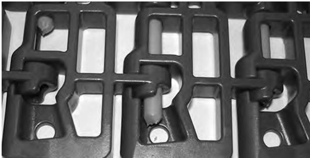
**Figura 121:** Asegurarse de que la varilla esté totalmente introducida
