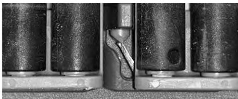
**Figura 249:** Asegurarse de que la varilla pasa más allá del sistema de retención
