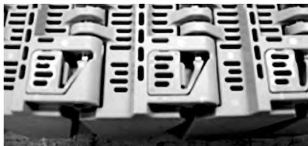
**Figura 101:** Asegurarse de que el sistema de retención está cerrado
