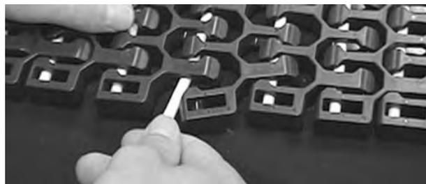
**Figura 311:** Insertar la varilla en las bisagras
