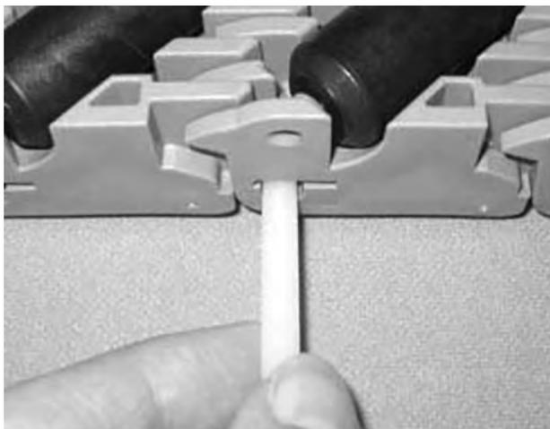
**Figura 225:** Insertar la varilla en las bisagras
