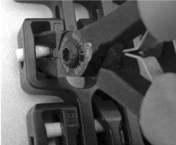
**Figura 321:** Empujar la varilla hacia el costado y más allá del orificio
