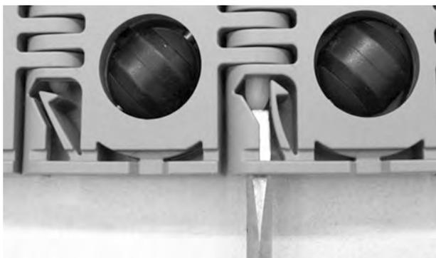
**Figura 56:** Inserte la varilla hasta pasar el sistema de retención
