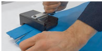
Figura 58: Ferramenta portátil de preparação da esteira
