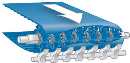
Figura 10: Instalação das engrenagens externas
