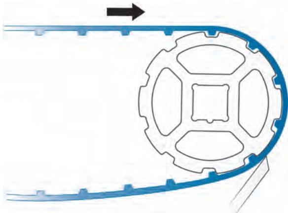
**Figura 20:** Raspador montado em ângulo
