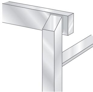
**Figura 6:** Corrija a montagem da junta
