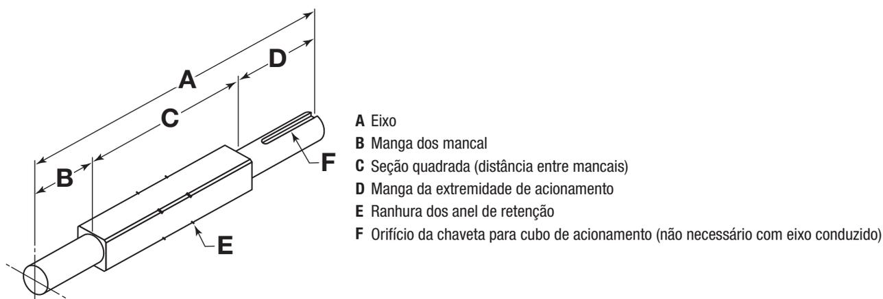
**Figura 9:** Componentes do eixo de acionamento quadrado
