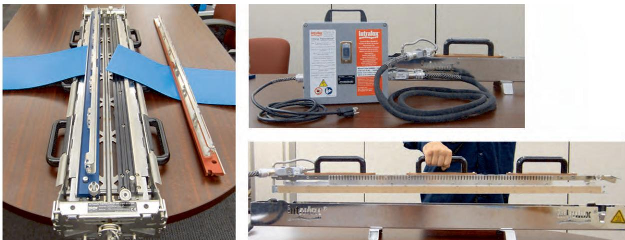
Figura 56: Sistema de emenda e componentes ThermoDrive V2
