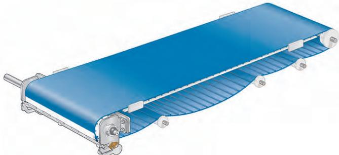
Figura 30: Curvatura catenária entre os componentes
