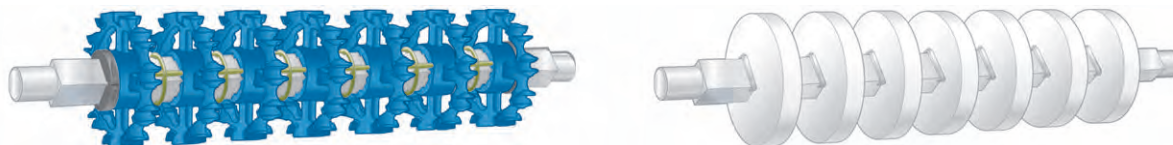
Rysunek 3: Wały z zablokowanymi elementami
