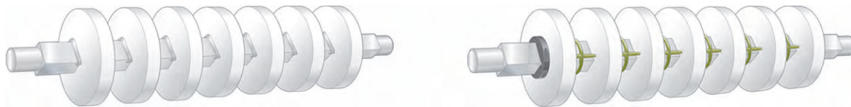
Rysunek 21: Pierścienie ustalające i elementy dystansowe kół zębatach
